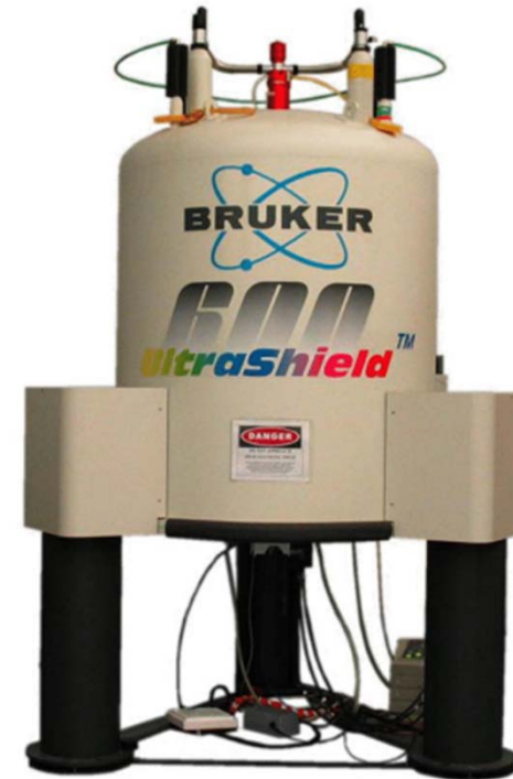
Espectrómetro de RMN operando a una frecuencia de ^1\text{H} de 600 MHz
